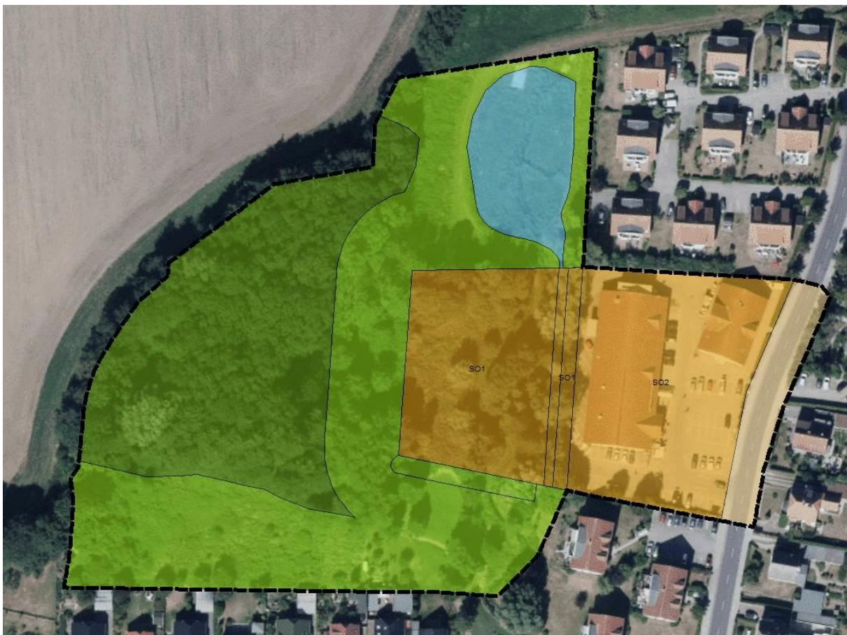
Abbildung 2: Übersicht über geplante Flächennutzungen gemäß B-Plan (dkl.grün= Wald, grün=private Grünflächen, orange= Sondergebietsflächen, blau= Wasserflächen, gelb= Verkehrsflächen)
